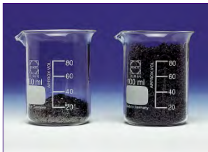
Le graphite agit comme un agent ignifuge grâce à son effet de gonflement unique.
