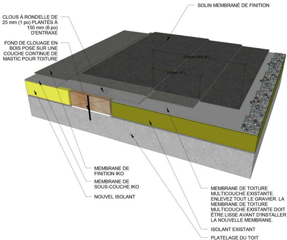
**Raccordement d'une toiture multicouche à bord biseauté**
