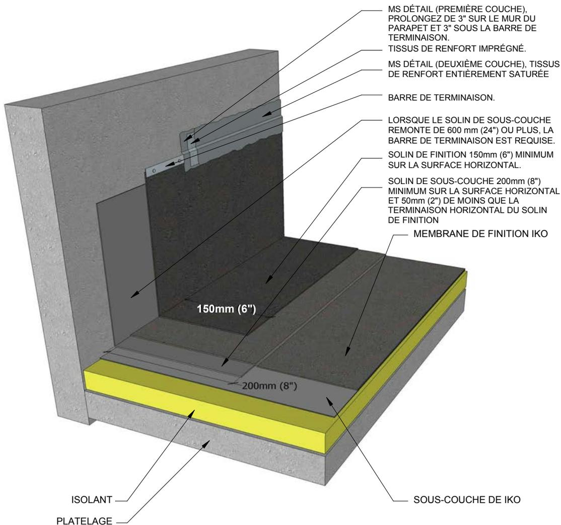
**Fixation du périmètre de la membrane de sous-couche à l'horizontale**
