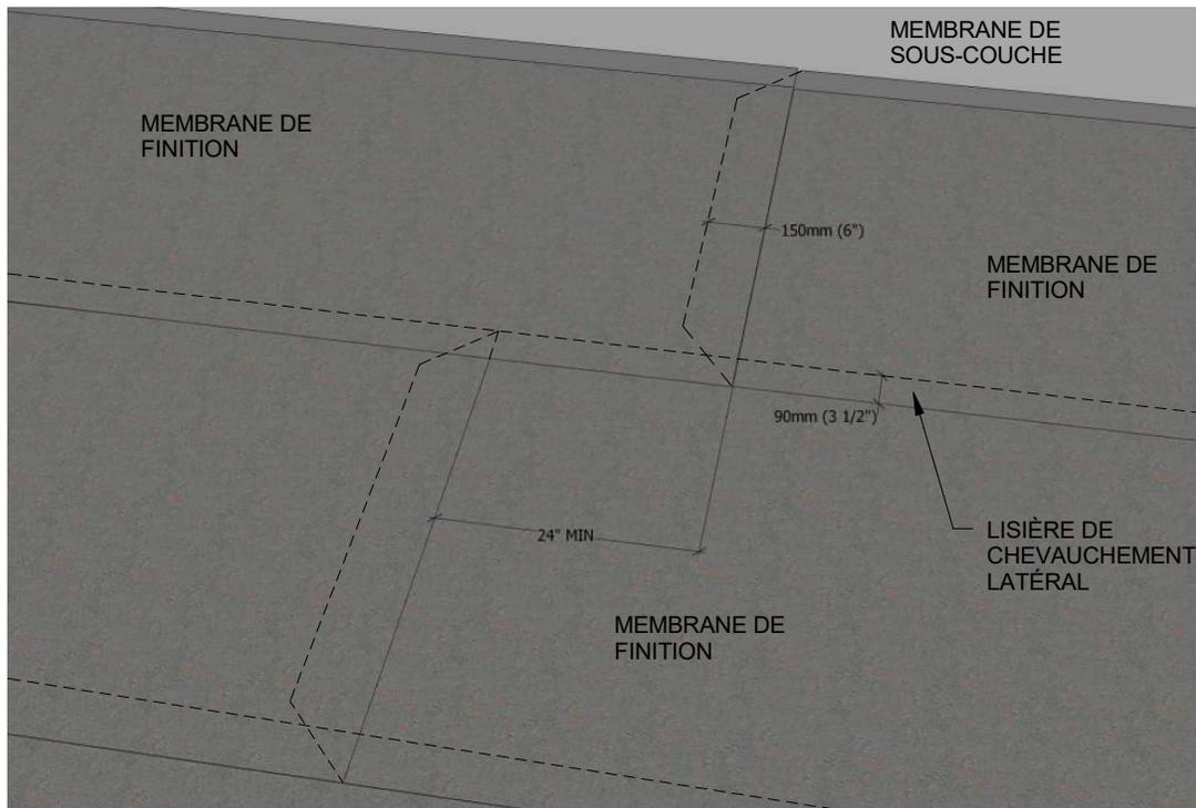
**Solins membranés de sous-couche et de finition en bordure de toit**
