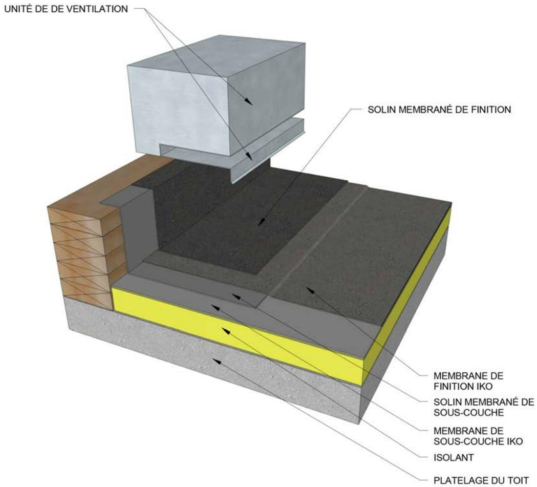
**Raccordement d'une toiture multicouche à une nouvelle toiture de même hauteur**
