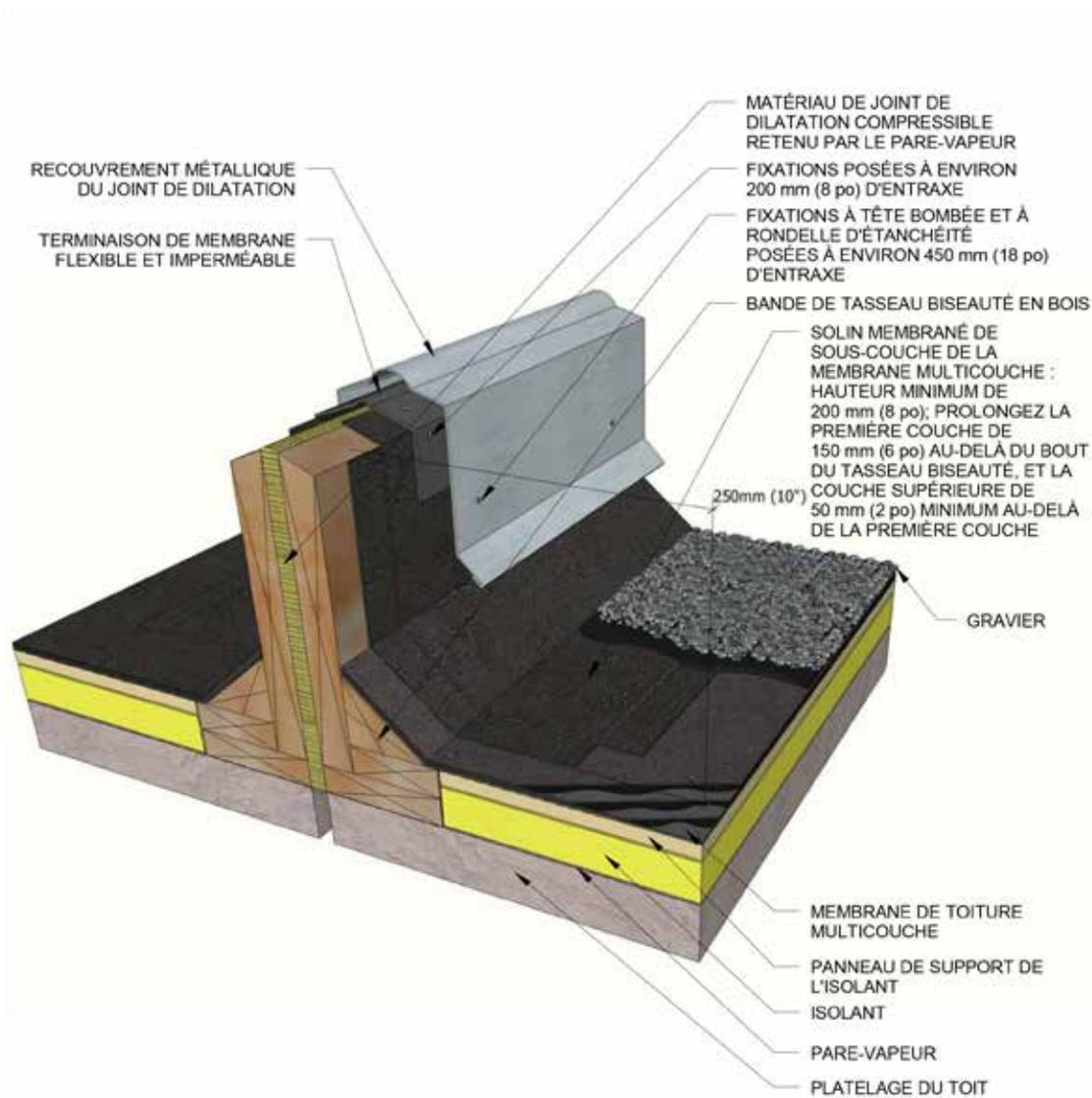
**Détail de solins de toitures multicouches - Joint de contrôle du système de toiture**
