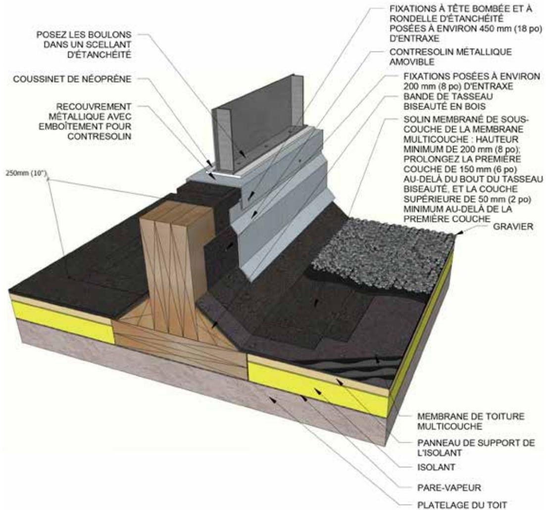
**Détail de solins de toitures multicouches - Socle d'équipement et collerette pare-pluie de pénétration typique**
