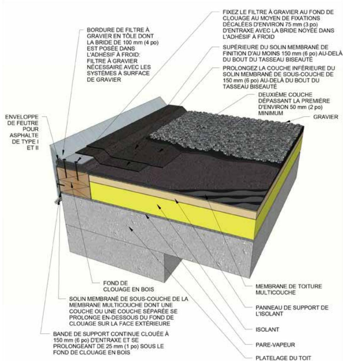
**Détail de solins de toitures multicouches - Solin membrané de sous-couche pour platelage non supporté par le mur**
