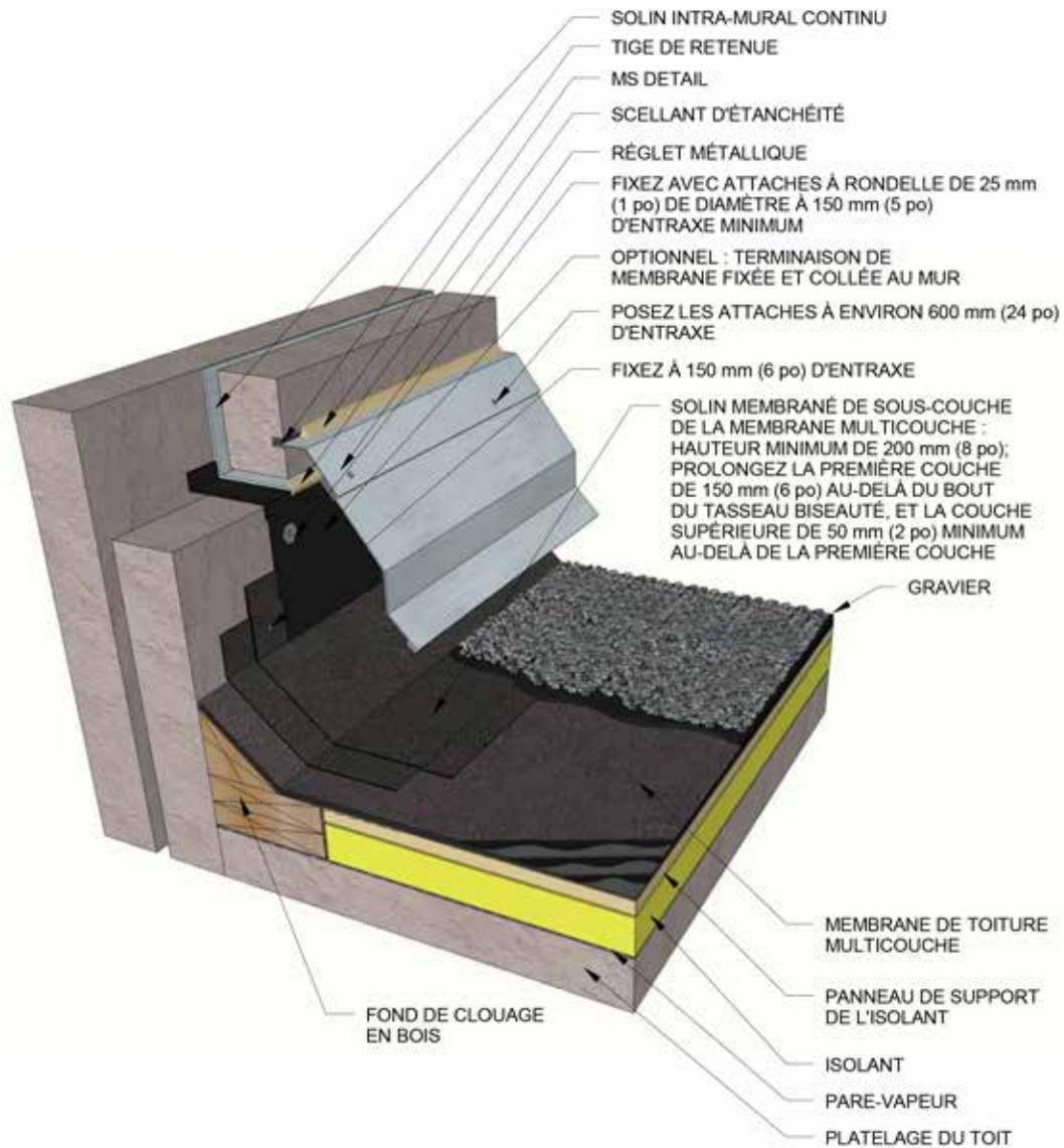
**Détail de solins de toitures multicouches - Contre-solin monté en applique pour murs de béton**
