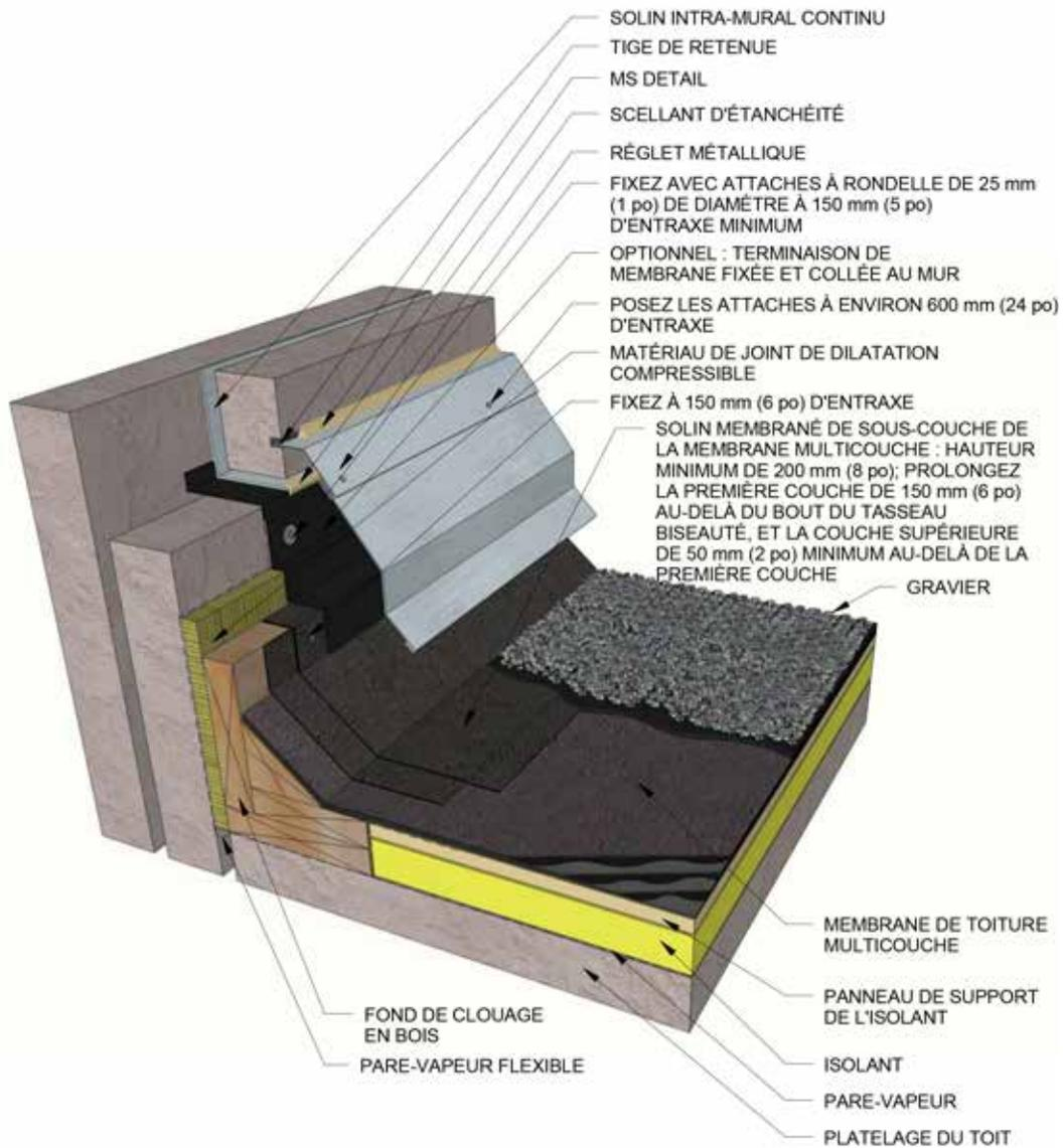
**Détail de solins de toitures multicouches - Solin membrané de sous-couche pour platelage supporté par le mur**
