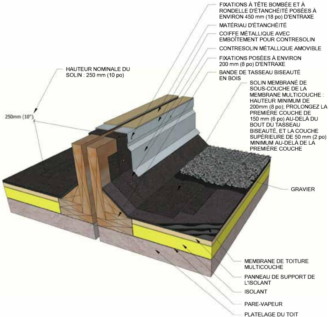
**Détail de solins de toitures multicouches - Solin de colonne isolée**
