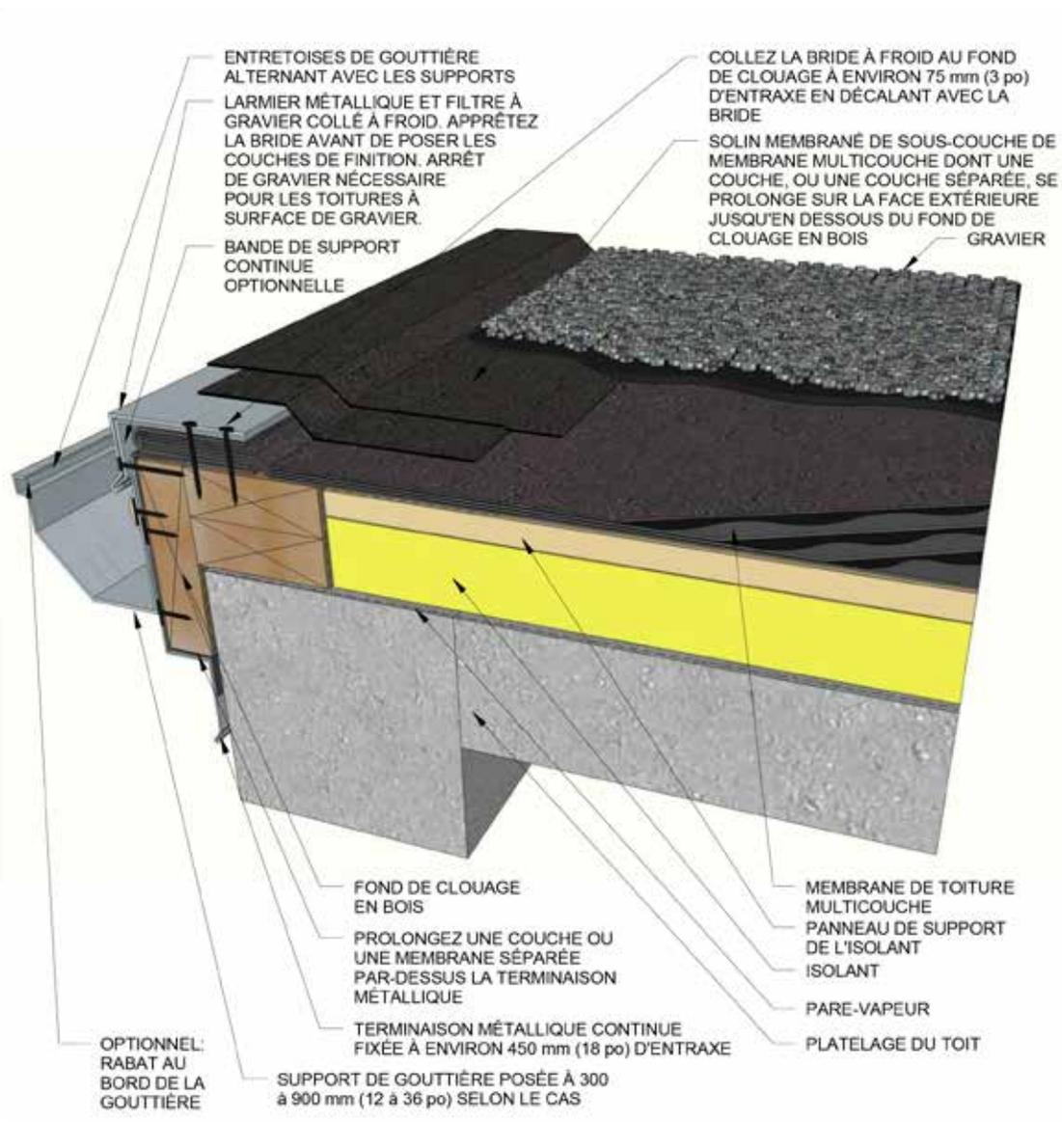
**Détail de solins de toitures multicouches - Barre de terminaison**
