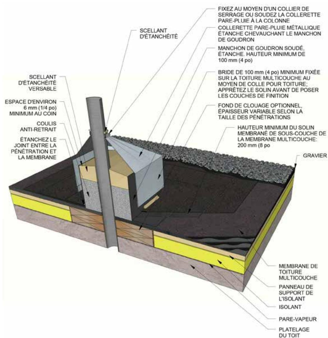
**Détail de solins de toitures multicouches - Drain de toit**
