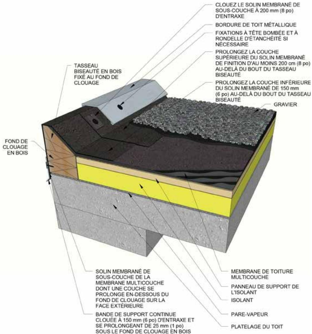
**Détail de solins de toitures multicouches - Dalot traversant le bord du toit**
