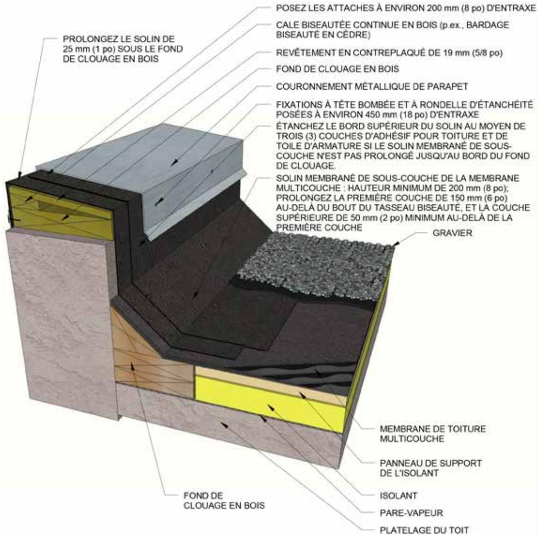
**Détail de solins de toitures multicouches - Joint de dilatation avec couvre-joint métallique**
