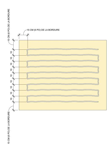
Détail de l'adhésif MILLENNIUM<sup>MC</sup> appliqué à entraxes de 30 cm (12 po) pour PROTECTOBASE<sup>MC</sup>, et SHIELDBASE<sup>MC</sup>
