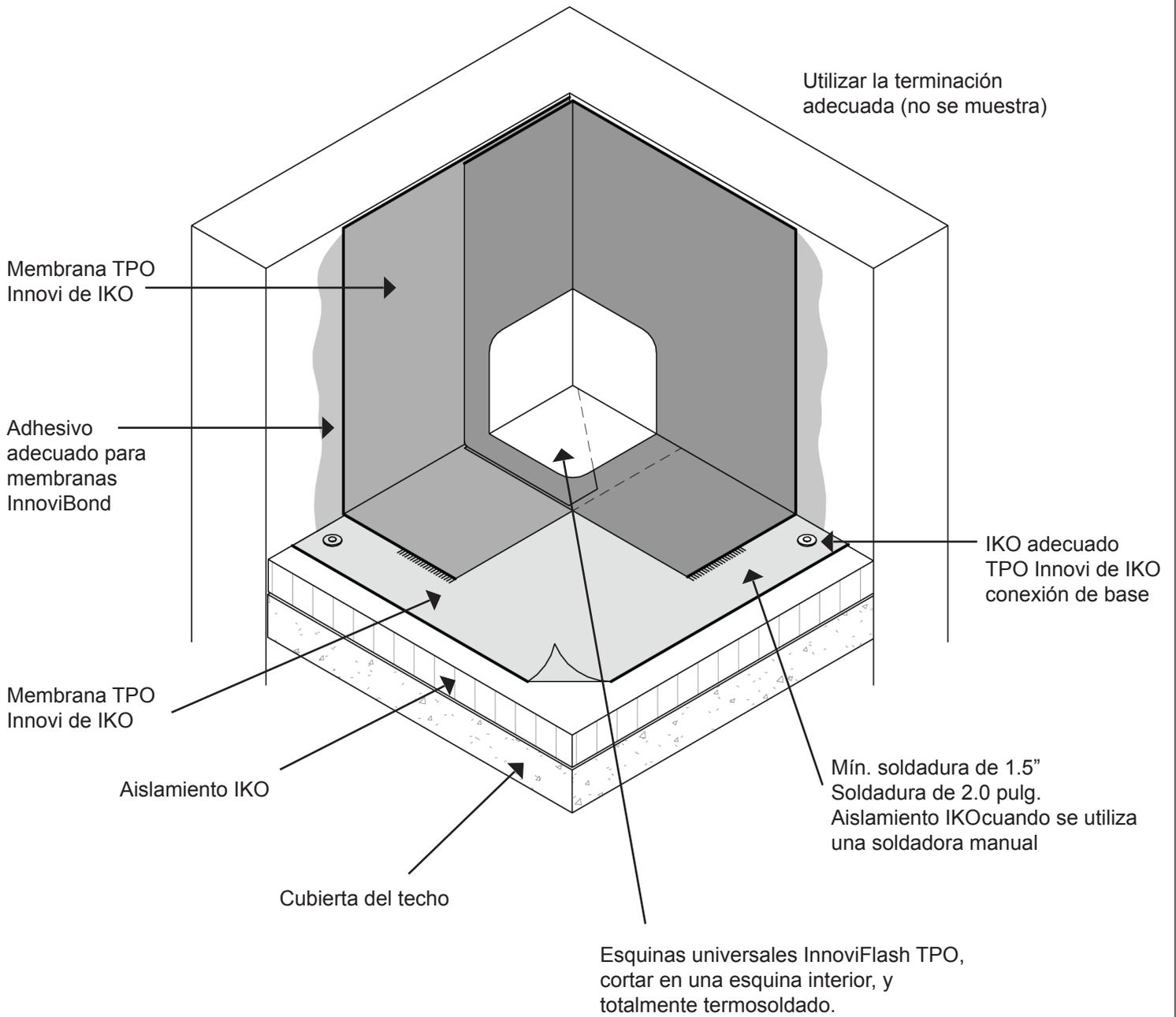
Aplicar el sellador de bordes Innoviseal TPO en todos los bordes cortados o expuestos de la membrana.
