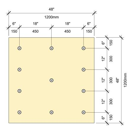
PATRÓN DE SUJETACIÓN DEL AISLAMIENTO: TABLERO DE 4' X 4', 11 SUJETADORES
