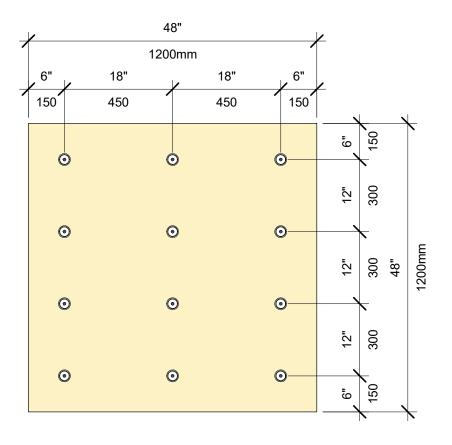
PATRÓN DE SUJETACIÓN DEL AISLAMIENTO: TABLERO DE 4' X 4', 12 SUJETADORES
