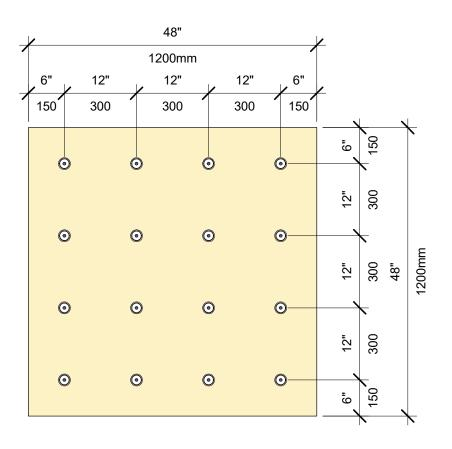
PATRÓN DE SUJETACIÓN DEL AISLAMIENTO: TABLERO DE 4' X 4', 16 SUJETADORES
