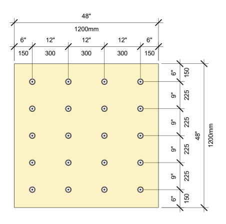
PATRÓN DE SUJETACIÓN DEL AISLAMIENTO: TABLERO DE 4' X 4', 20 SUJETADORES
