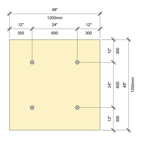
PATRÓN DE SUJETACIÓN DEL AISLAMIENTO: TABLERO DE 4' X 4', 4 SUJETADORES
