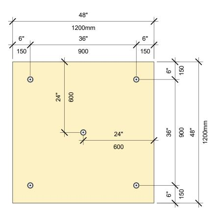
PATRÓN DE SUJETACIÓN DEL AISLAMIENTO: TABLERO DE 4' X 4', 5 SUJETADORES
