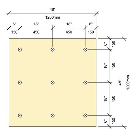
PATRÓN DE SUJETACIÓN DEL AISLAMIENTO: TABLERO DE 4' X 4', 9 SUJETADORES
