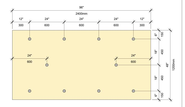
PATRÓN DE SUJETACIÓN DEL AISLAMIENTO TABLERO DE 4' X 8', 10 SUJETADORES
