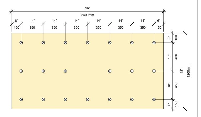
PATRÓN DE SUJETACIÓN DEL AISLAMIENTO TABLERO DE 4' X 8', 20 SUJETADORES
