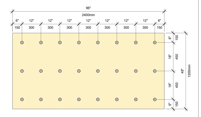
PATRÓN DE SUJETACIÓN DEL AISLAMIENTO TABLERO DE 4' X 8', 24 SUJETADORES
