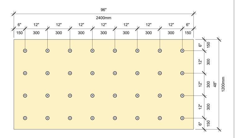
PATRÓN DE SUJETACIÓN DEL AISLAMIENTO TABLERO DE 4' X 8', 32 SUJETADORES
