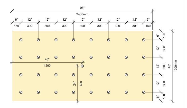
PATRÓN DE SUJETACIÓN DEL AISLAMIENTO TABLERO DE 4' X 8', 33 SUJETADORES
