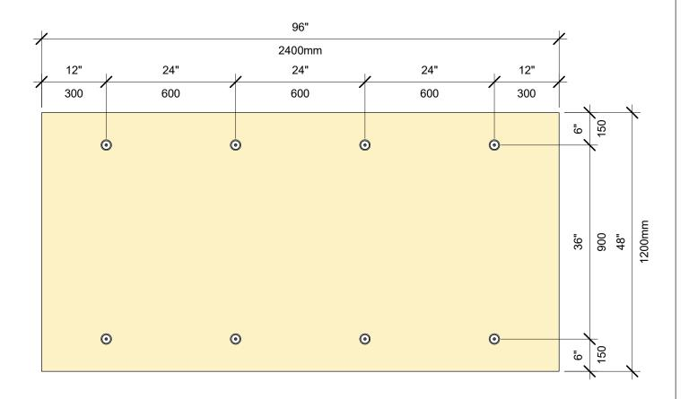
PATRÓN DE SUJETACIÓN DEL AISLAMIENTO TABLERO DE 4' X 8', 8 SUJETADORES
