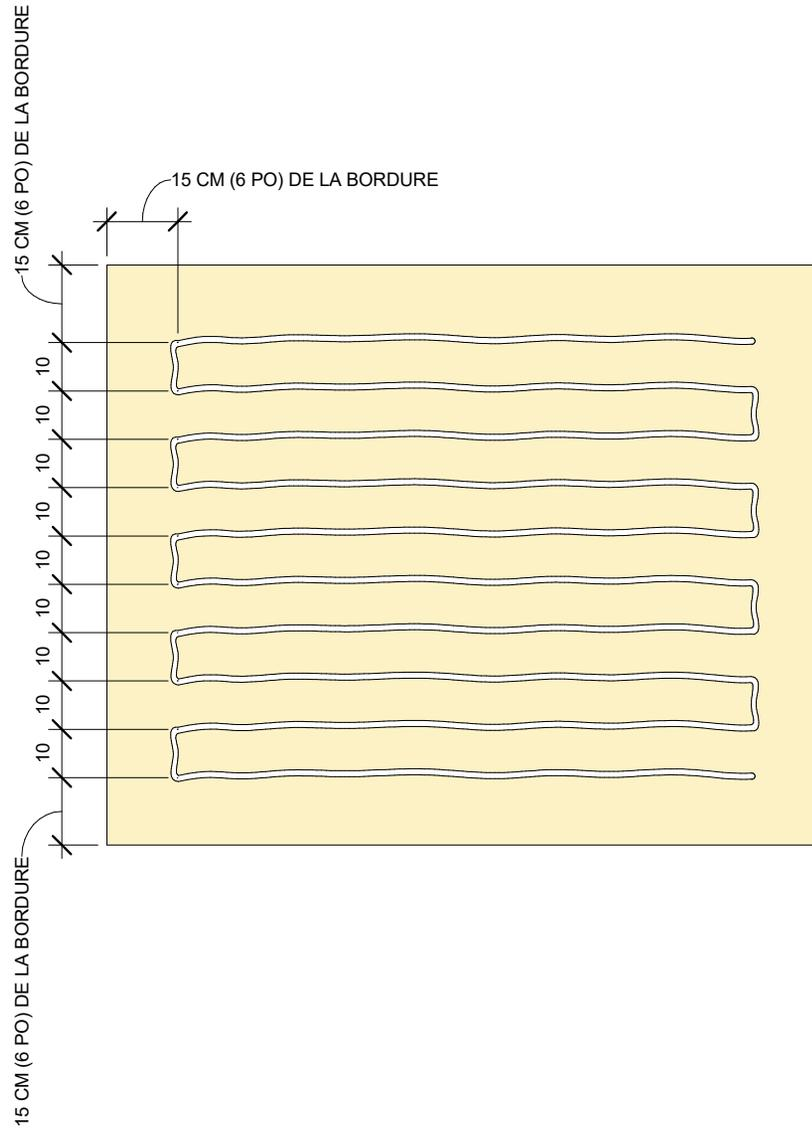
**Détail de l'adhésif MILLENNIUM<sup>MC</sup> appliqué à entraxes de 30 cm (12 po) pour PROTECTOBASE<sup>MC</sup>, et SHIELDBASE<sup>MC</sup>**
