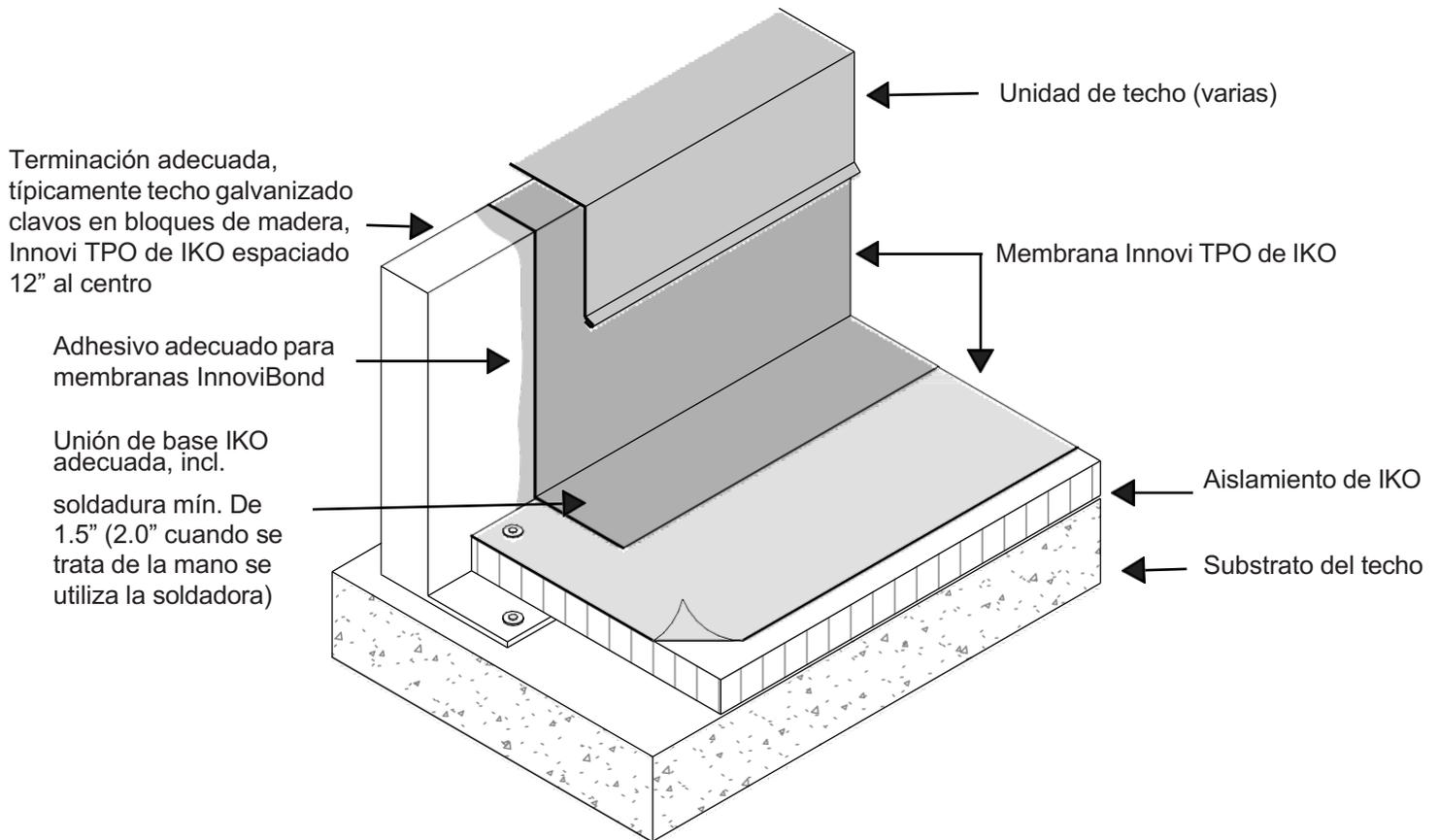
**Aplicar el sellador para bordes InnoviSeal TPO en todos los bordes cortados o expuestos de la membrana.**
