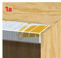
Utilizar IKO GoldSeam para sellar entre el alero y el imposta. La instalación de aproximadamente 4" de esta cinta sobre la abertura proporciona un tapajuntas y una protección superior del alero. Su extrema flexibilidad asegura que no se agrietará ni desgarrará y la cinta es ultra-adhesiva para ayudar a asegurar un sellado hermético. Crea una barrera altamente efectiva contra la infiltración de agua potencialmente dañina y ayuda a impedir el acceso de insectos y roedores al espacio del ático.
