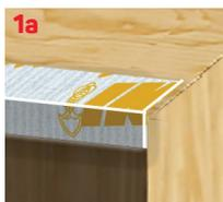
Utiliser IKO GoldSeam pour étanchéifier l'espace entre l'avant-toit et la rive de toit. La pose de ce ruban de 10 cm (4 po) sur cet espace procure un solin d'avant-toit de protection supérieure. Sa très grande souplesse garantit qu'il ne se fissurera ni ne se déchirera et sa capacité d'adhérence assure un joint étanche. Barrière très efficace contre l'infiltration d'eau, il contribue aussi à décourager l'accès aux insectes et à la vermine dans le grenier.
