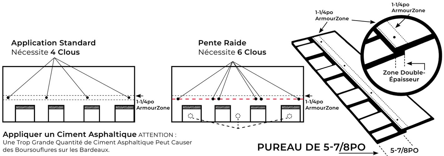
**Appliquer un Ciment Asphaltique** ATTENTION : Une Trop Grande Quantité de Ciment Asphaltique Peut Causer des Boursouffures sur les Bardeaux.
