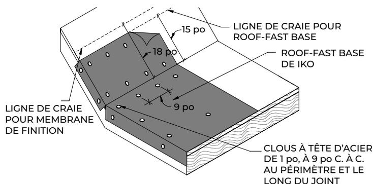
DÉTAIL DE RACCORDEMENT POUR PENTE RAIDE
