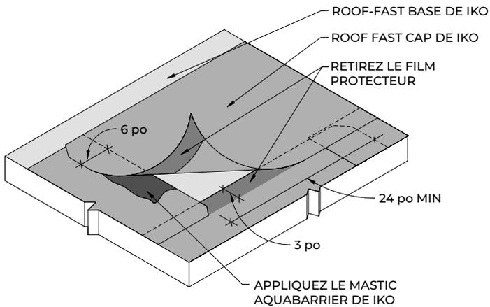
DÉTAIL DU RACCORD D'EXTRÉMITÉ
