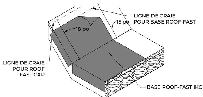
DÉTAIL DE RACCORDEMENT POUR PENTE RAIDE
