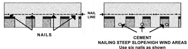
PROPER APPLICATION REQUIRES THAT THE NAILS PENETRATE <u>BOTH</u> THE OVERLAY AND UNDERLAY PORTIONS OF THE SHINGLE.
