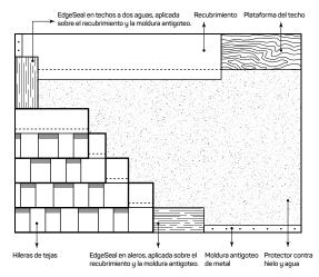
El iniciador de techo deben instalarse siguiendo todas las instrucciones de aplicación de IKO. Aquí se destacan algunos requisitos de instalación:
