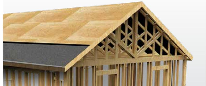
**Opción 1:****Sellar la Cubierta con Cinta de Sellado de Techos y Membrana Impermeabilizante Sintética**
